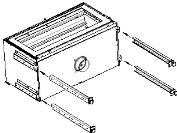
1. Regular la altura y fijarlas con los tornillos. Para montar la caja de la turbina es necesaria una altura mínima de 175mm.
