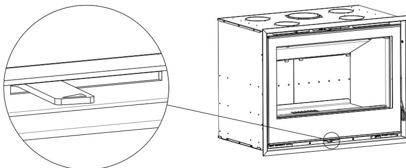
**PRIMARY AIR REGULATION LEVER POSITION FOR NOMINAL POWER, LEAVE OPEN 25% OF ITS RANGE (10mm.).**
