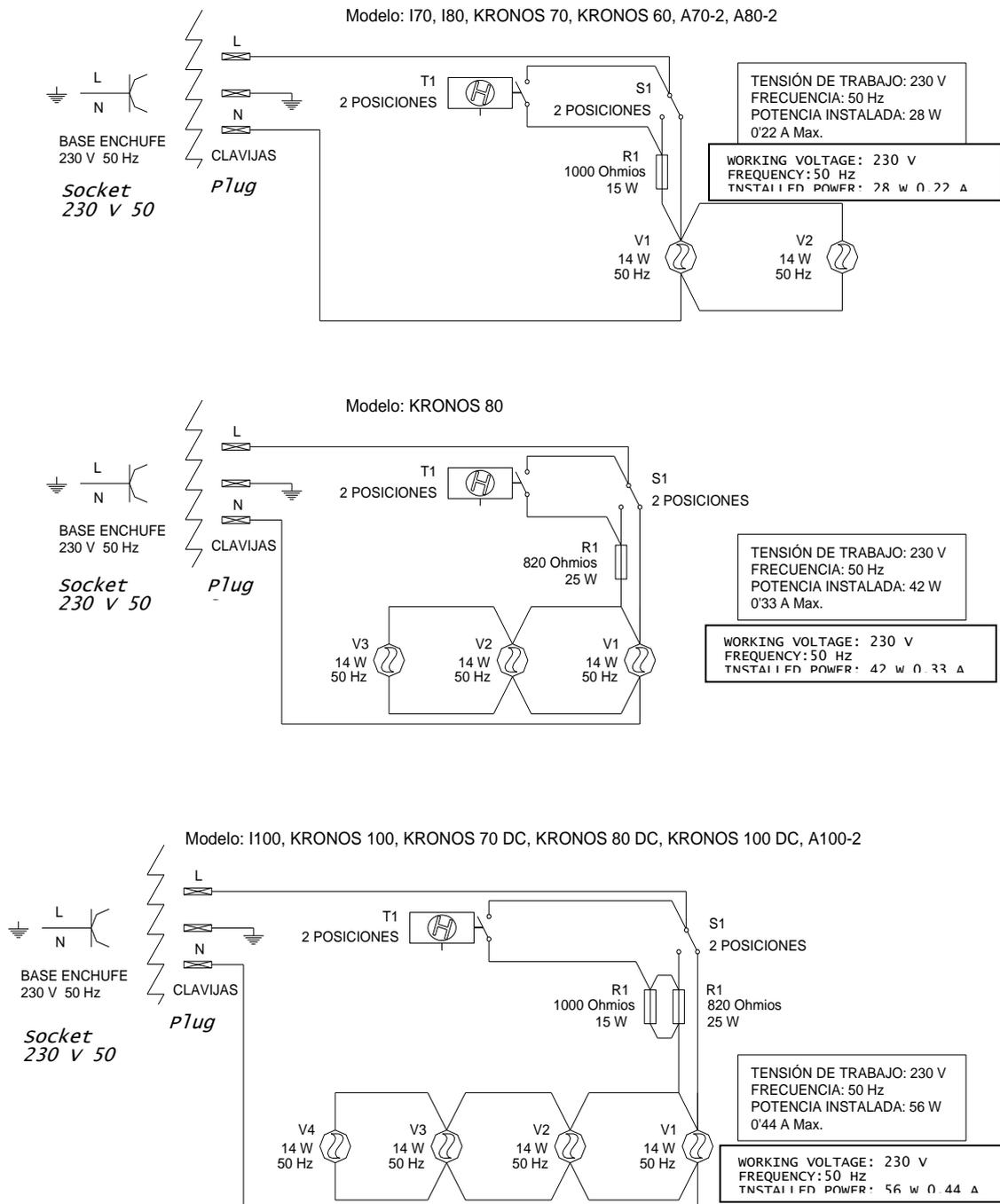
Nota.- El cable de alimentación debe conectarse mediante un enchufe o clavija a una base de toma de corriente y debe quedar accesible una vez instalado el aparato. La manipulación o sustitución del cable de alimentación o componentes eléctricos debe ser realizada por personal cualificado con el fin de evitar un peligro.
